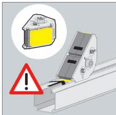
Lato corto del raccordo Steptec su un lato aperto del binario.
