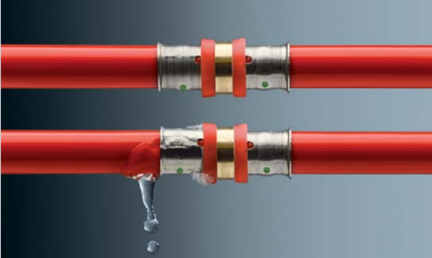
Viega SC-Contur: la sicurezza di individuare i raccordi eventualmente non pressati già durante la prova di tenuta.
