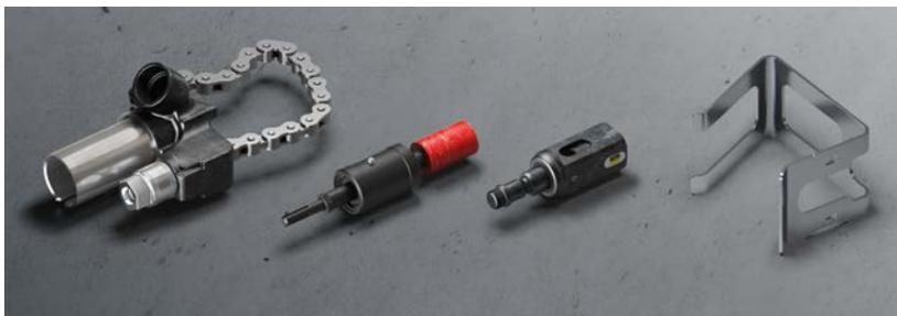
Fig. 1-7 Il set utensili per l'inserto di presa filettato con collegamento a pressare comprende tutto il necessario per realizzare derivazioni in installazioni già esistenti: dispositivo di centraggio, fresa a tazza e utensile per l'applicazione sulla pressatrice
