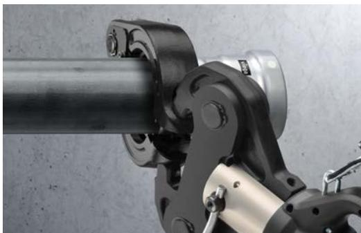
Fig. 4-5 Pressatura con corone snodate
