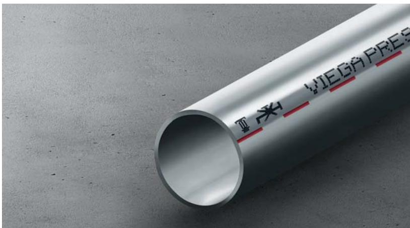
Fig. 2-1 I tubi Prestabo per impieghi speciali, zincati esternamente e internamente tipo sendzimir, sono chiaramente identificati da una linea rossa tratteggiata, da un simbolo nero e da una scritta nera "Sprinkler"
