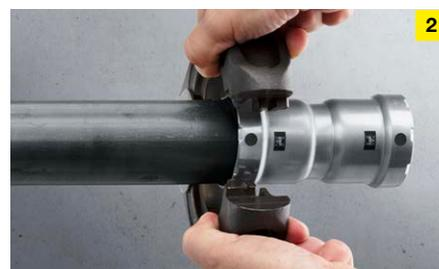
Per pressare i raccordi Megapress a partire da 1"  $\frac{1}{4}$  si usano esclusivamente le corone con ganaschia ad accoppiamento snodato. Nelle dimensioni più piccole, comprese tra  $\frac{3}{8}$ " e 1", si può scegliere tra ganasce o corone con ganaschia ad accoppiamento snodato.
