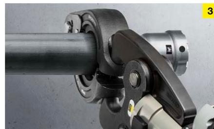
Il raccordo viene pressato in tempi rapidissimi con una pressatrice Viega e collegato al tubo.
