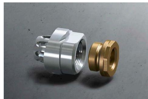
L'inserto di presa filettato femmina Rp 3/4" con collegamento a pressare è disponibile per tubi di dimensioni da 1" 1/2 a 6" idonei al sistema Megapress. Un manicotto ridotto Rp da 1/2", opzionale, completa la gamma. L'inserto di presa con collegamento a pressare Megapress non è adatto per impianti a gas.
