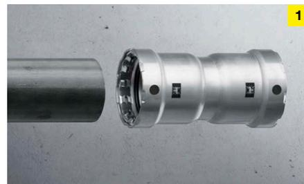
Il tubo di acciaio viene tagliato su misura e pulito. Dopodiché viene misurata e marcata la profondità di innesto. Successivamente, il raccordo Megapress viene inserito sul tubo fino alla marcatura.
